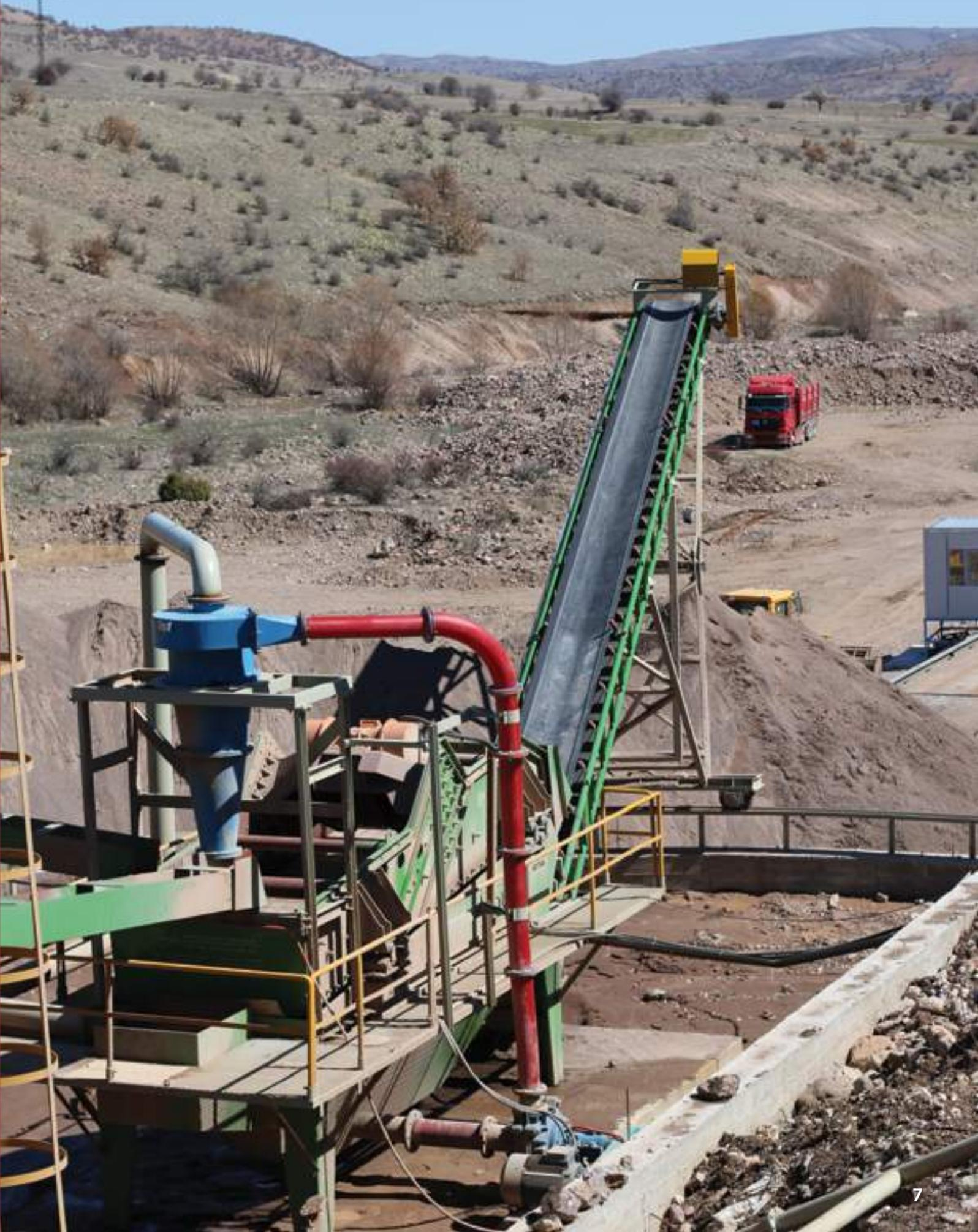
Полиуретановые гидроциклоны могут быть изготовлены диаметром от Ø25 мм до Ø700 мм. Гидроциклоны используются в разных производственных процессах в качестве главных или вспомогательных компонентов. При производстве сложных циклонов вместе с вершиной циклона (желаемый размер выхода), вихрем циклона, промежуточным телом, циклонной улиткой, погружением трубы и другими крепежными деталями изготавливаются на заказ.
